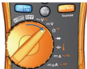
要打开万用表电源，请将旋转开关转到任何其他位置。
