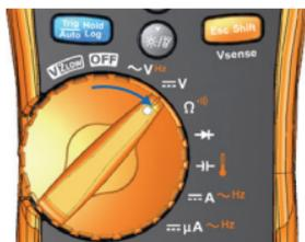
Pour mettre le multimètre sous tension, tournez le commutateur rotatif sur toute autre position.
