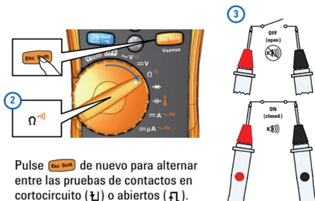
Pulse  $Esc Shift$  de nuevo para alternar entre las pruebas de contactos en cortocircuito ( $\text{⏏}$ ) o abiertos ( $\text{⏏}$ ).
