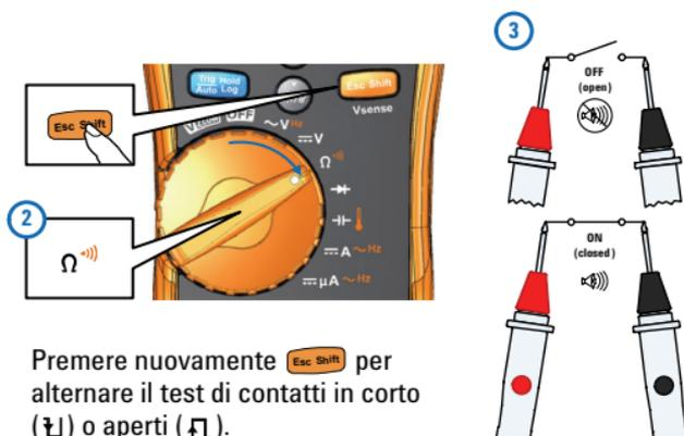
Premere nuovamente **Esc Shift** per alternare il test di contatti in corto (⎓) o aperti (⏏).
