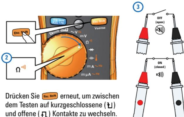
Drücken Sie **Esc Shift** erneut, um zwischen dem Testen auf kurzgeschlossene (⚡) und offene (⚡) Kontakte zu wechseln.
