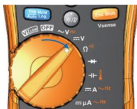
Drehen Sie zum Einschalten des Multimeters den Drehregler auf eine beliebige Position.
